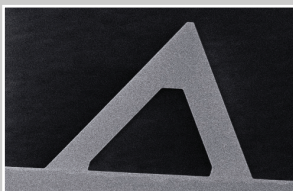
Pyrex-Nitride AFM探针 放大的三角无探针长悬臂梁
