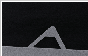
Pyrex-Nitride AFM探针 放大的三角无探针短悬臂梁
