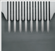
Arrow™ TL8 无探针悬臂梁阵列、 单晶硅支架上的八个悬臂梁
