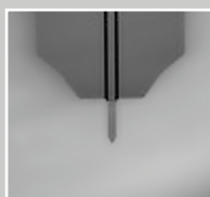
Arrow™ TL1 ティップレスカンチレバー サポートチップにカンチレバー が1本形成されている
