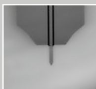
Arrow™ TL1 Cantilever sin punta, cantilever único sobre un chip portador de silicio monocristalino
